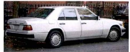
250 D Turbo (amerikanische Version) mit den typischen Lufteinlassschlitzen im rechten Kotflügel
